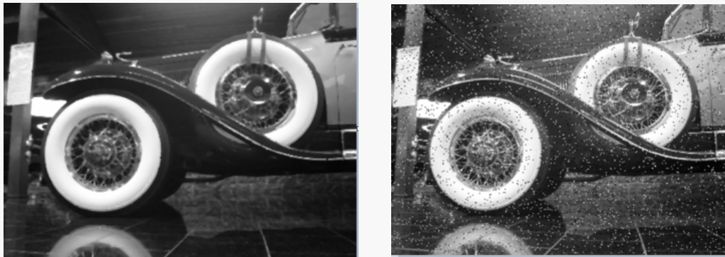
الشكل 10: صورة مع وجود تشويش وصورة بعد فعل المصفاة الوسيطة
